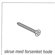
skrue med forsenket hode
